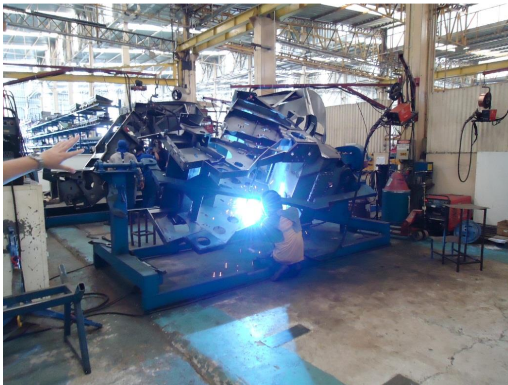
Figura 18: Processo de Solda em dispositivo giratório Fonte: Pedertractor S/A.
