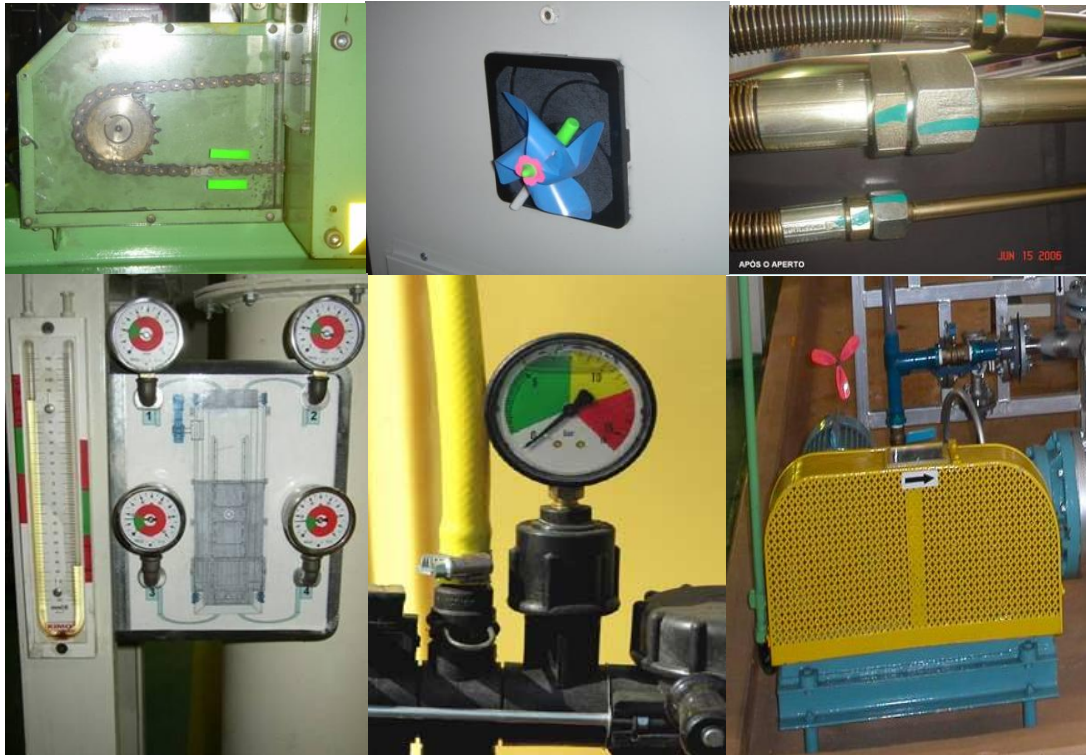
Figura 8: Fotos de indicadores visuais para facilitar a inspeção dos equipamentos.
