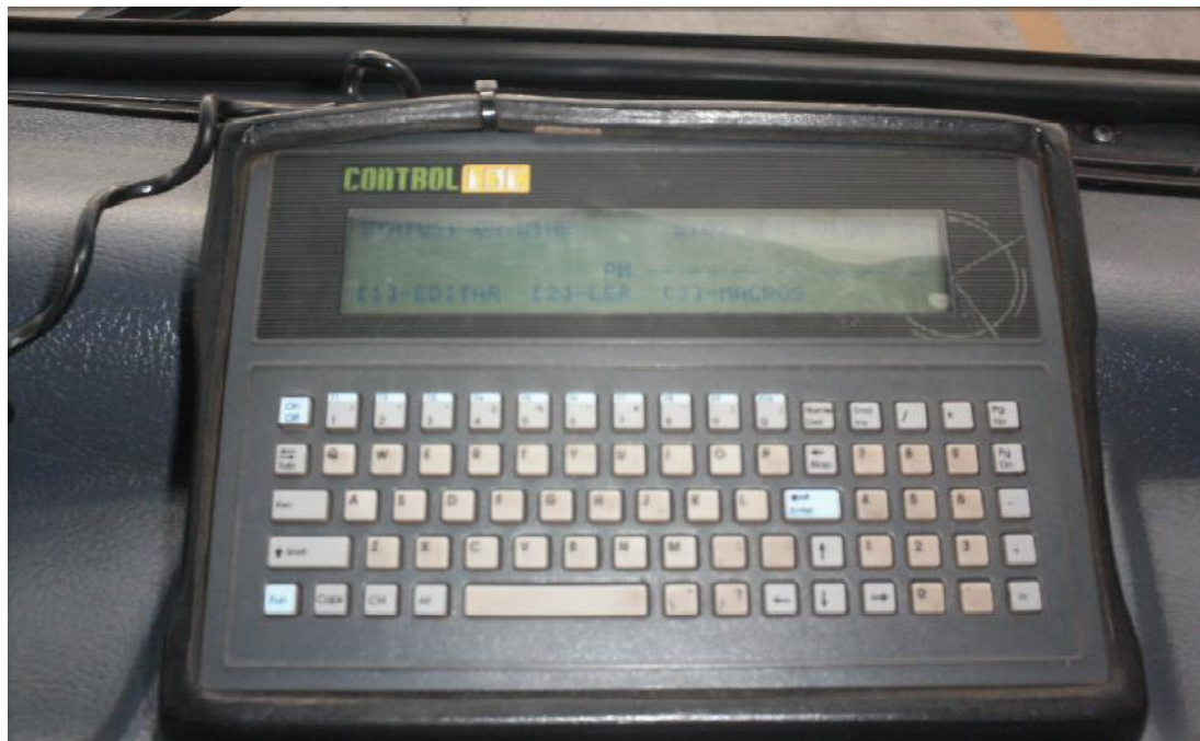
Figura 03: Computador de bordo Controlloc no caminhão da JSL
